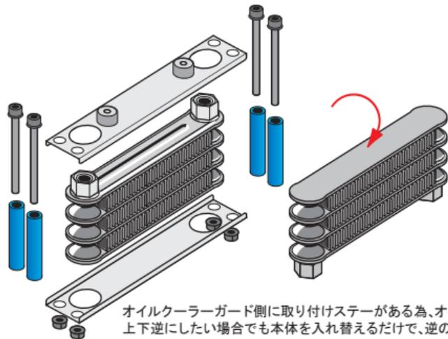
オイルクーラーガード側に取り付けステーがある為、オイルクーラー本体の取り回して上下逆にしたい場合でも本体を入れ替えるだけで、逆の取付けが可能です。
